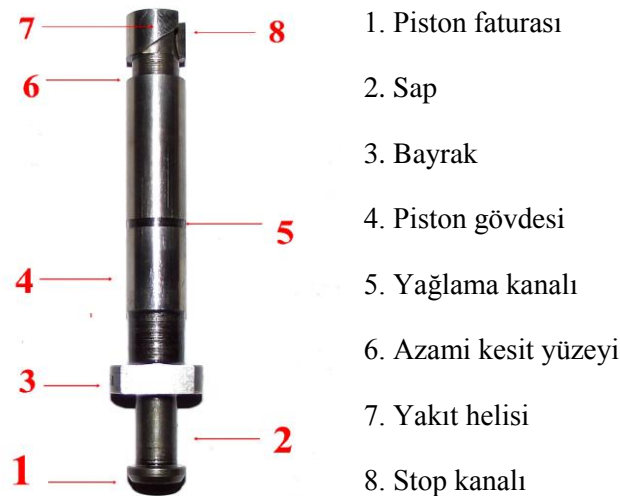
Resim 1.14: Eleman pistonu
