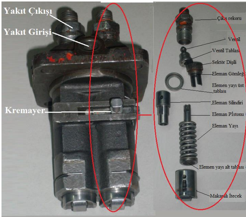
Resim 1.3: İki silindir için kullanılan PF tipi yakıt enjeksiyon pompası
