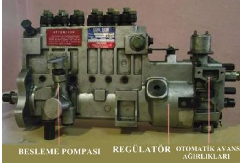
Resim 1.19: Avans tertibatının pompa üzerindeki yeri
